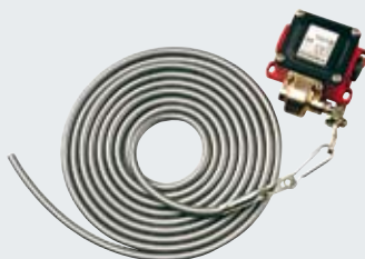
Interruptor de tracción con cable de tracción de material sintético Montaje horizontal o vertical posible, carcasa de aleación inyectada de aluminio IP 65, largo de cable 4 m.
